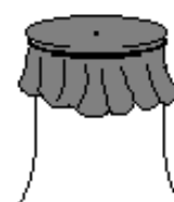
圖 5.2. 錐形瓶瓶口的做法。
